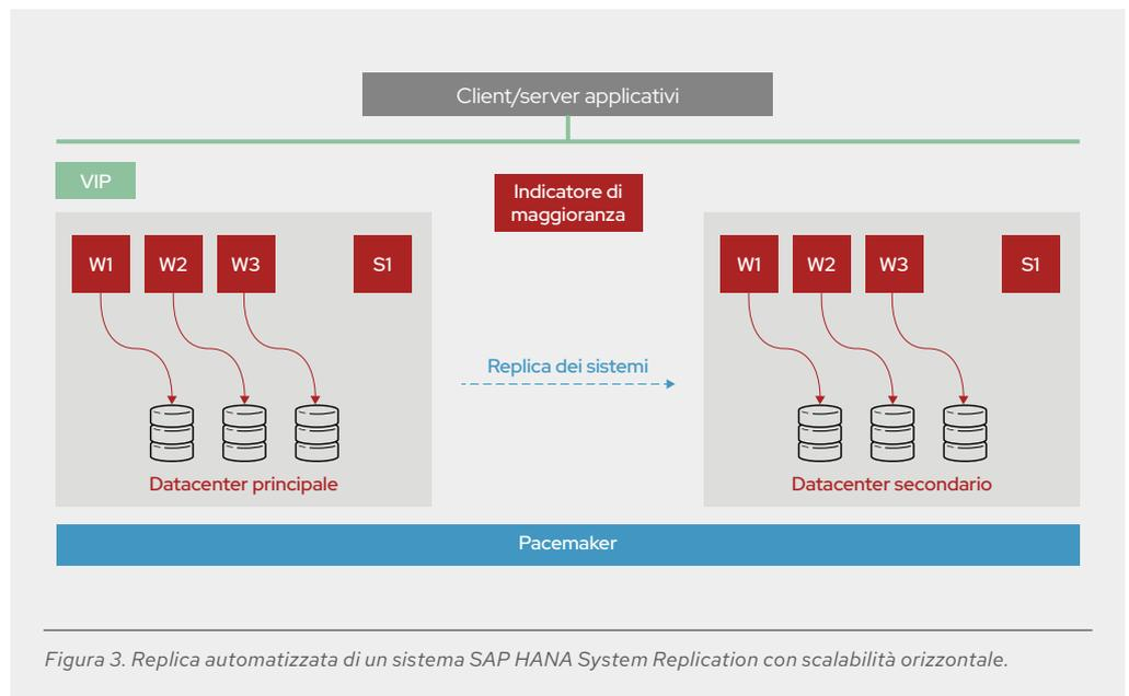
Figura 3. Replica automatizzata di un sistema SAP HANA System Replication con scalabilità orizzontale.
